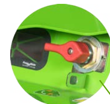
Główny wyłącznik akumulatora
