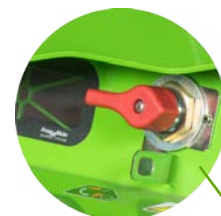
Główny wyłącznik akumulatora
